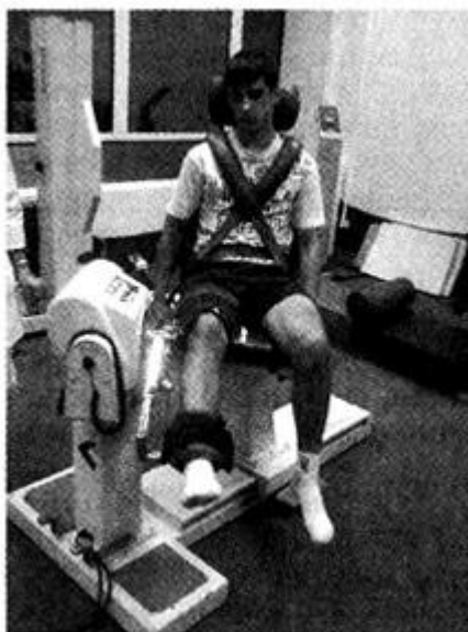
Рис. 13. Процедура изокинетического тестирования силовых возможностей футболиста на аппарате Biodex (США)
